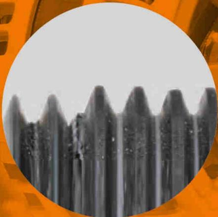
سایش ناهموار دندانه ها
